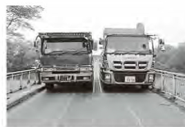
載荷試験状況
