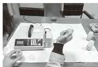
電量滴定方式デジタル塩分測定器による試験状況
