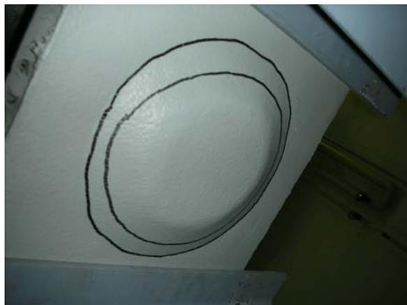
図5 押抜き試験時の塗膜変形の状況
