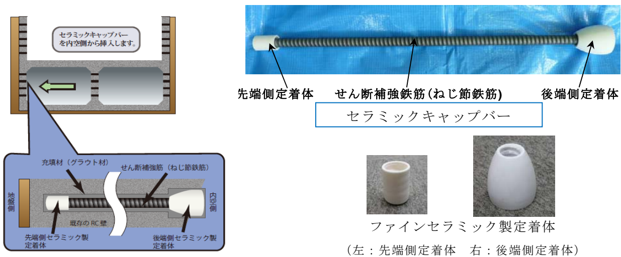
セラミックキャップバーによる後施工せん断補強
