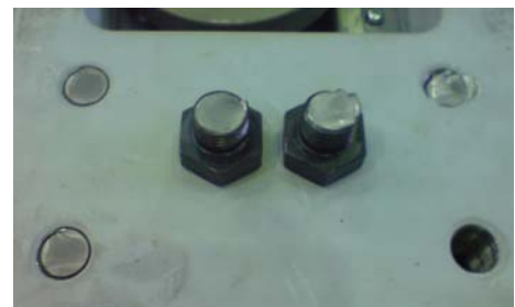
写真 3 試験後のセットボルト
