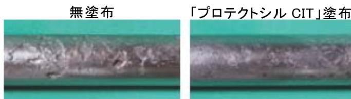
「4日間気中乾燥→3日間塩水浸漬」を55サイクル行い塩害促進後、試験体を解体し鉄筋の腐食状態を確認した。
