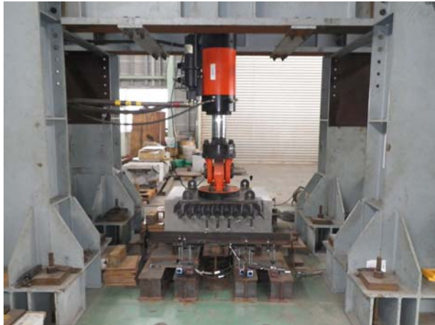
疲労試験状況
