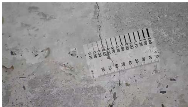
操作端末画面に表示させたクラックスケールおよび計測目盛
