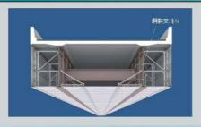
桁下にキュウサを設置できない場合で桁間に設置する形式。 桁間隔が裏面パネル支持間隔を超え、鋼製支持材および パネル受け部(アルミ受材)がある構造形式です。
