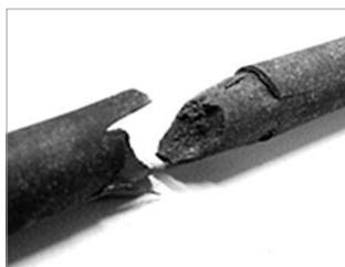
図-2 活性溶解型応力腐食試験によるPC鋼線の破面
